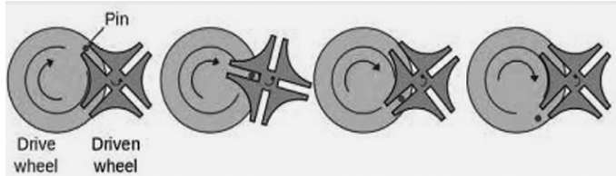
图3 “马耳他十字轮”啮合运动示意图
